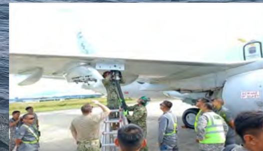
Tatacara pengisian minyak secara praktikal ke dalam pesawat P8-A
